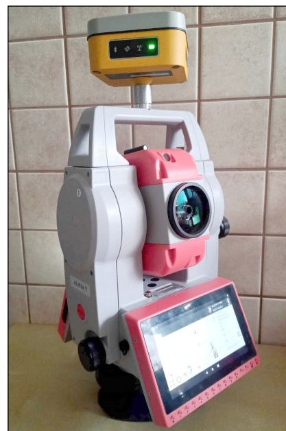
A GINTEC G20M RTK GNSS-vevővel (alias PoolLee, azaz Puli) kombinált ALFA-Y mérőállomás
