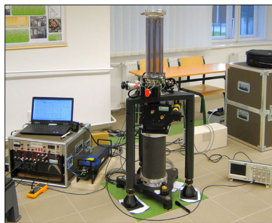
3. ábra. Mérés az FG5X típusú abszolút gradiométerrel az Oltay-féle ponton
