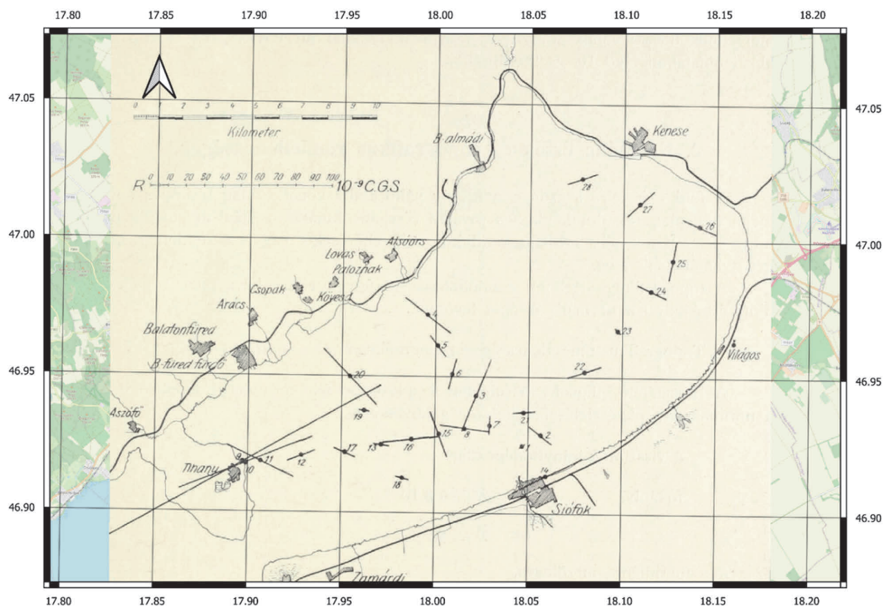
2. ábra: Eötvös ábrája az 1901. évi mérésekből meghatározott horizontális irányítóképesség értékeit mutatja a Balaton északkeleti medencéjében (Eötvös, 1908). A grafikus ábrázoláshoz a horizontális irányítóképesség szakaszok hosszát a 9. egyenlettel, a szakaszok irányát pedig a 10. egyenlettel lehet kiszámolni.
