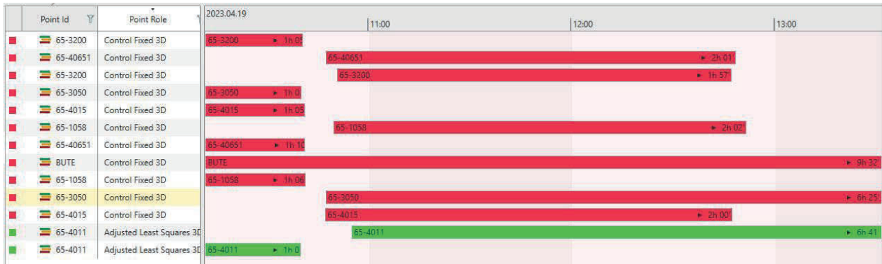
13. ábra. Gantt-diagram a GNSS mérés (Leica520+Topcon Net G3) időbeli lefolyásáról (Leica Infinity programból)
