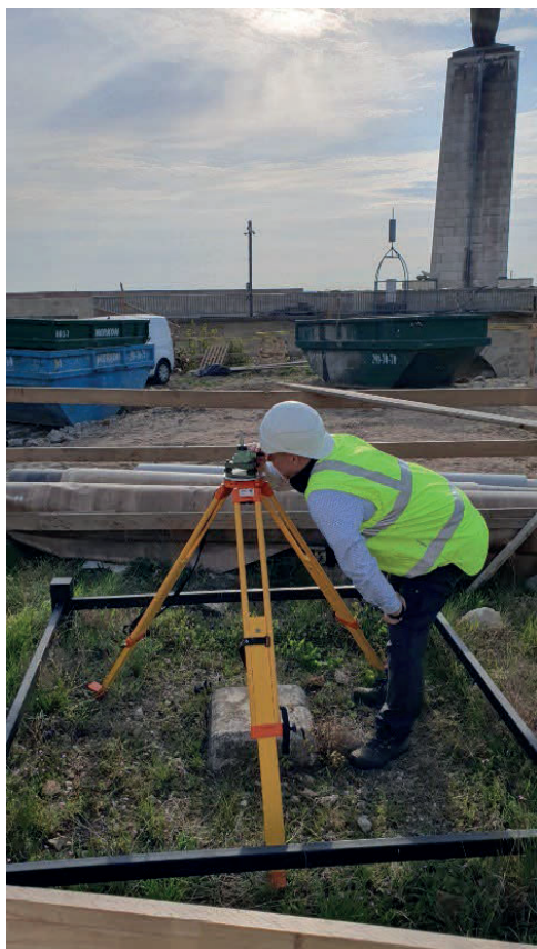
10. ábra. Pontraállítás a 65-4011 főponton.
