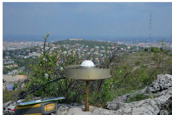
5. ábra. Topcon vevő a 65-3050 ponton.
