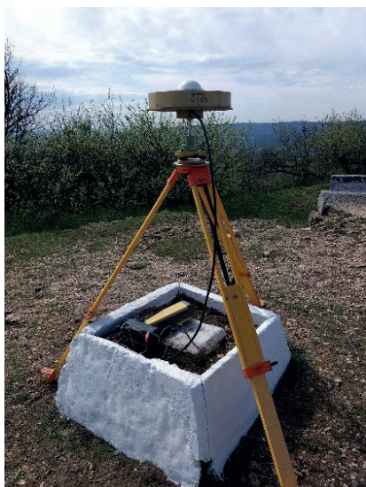
4. ábra. Topcon vevő a 65-1058 ponton.
