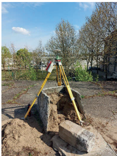
3. ábra. Leica GPS520 vevő a 65-4015 ponton.
