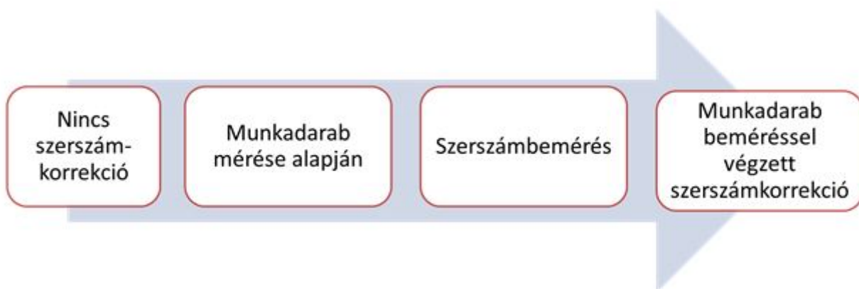
3. ábra: Szerszámkorrekciózás szintjei
