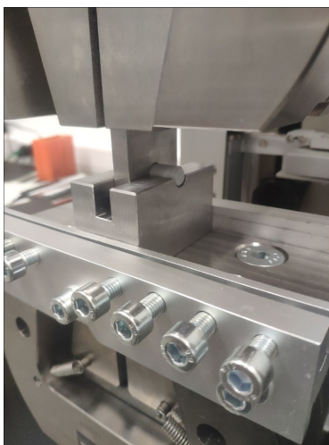
5. ábra: A nyírókészülékbe befogott próbatest nyírás előtt
