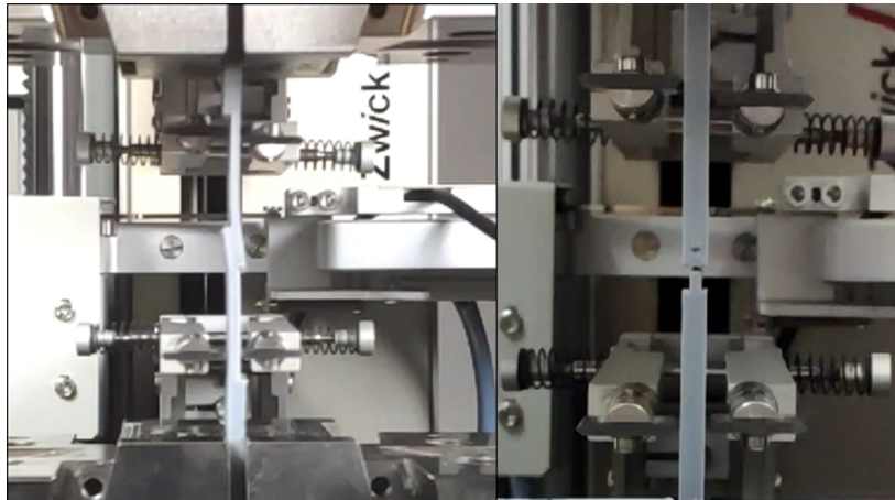
1. ábra: Az átlapolt próbatestek nyírési vizsgálata
