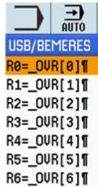
2. ábra: Szerszámparaméterekből R-paraméterek készítése
