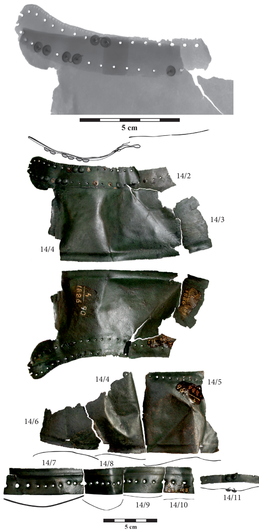
Fig. 6. The fragmented sheet-metal object from Szentgáloskér and its X-ray image (Appendix 14) 6. kép. A szentgáloskéri töredékes lemeztárgy és röntgenfelvétele (Appendix 14)
