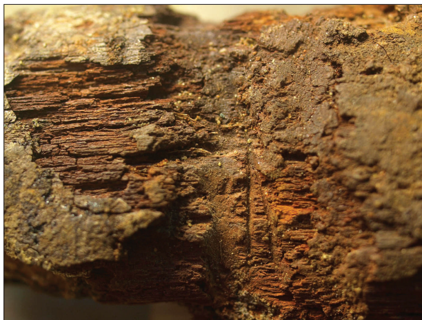
11. kép A markolaton fellelhető famegmunkálás nyomai Fig. 11 Traces of woodworking on the grip
