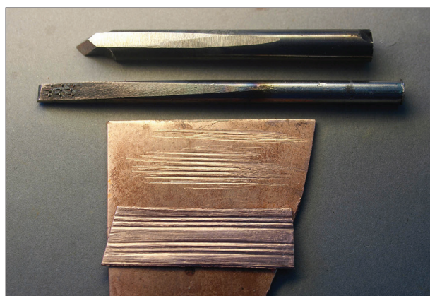
26. kép A szerszám és a készítéshez használt véső, valamint a kialakított ismétlődő minta és egy bordázott szalag
